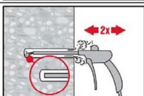
Bohrloch erneut vom Bohrl Lochgrund über die gesamte Länge 2-mal mit Druckluft ausblasen, bis die rückströmende Luft staubfrei ist.
