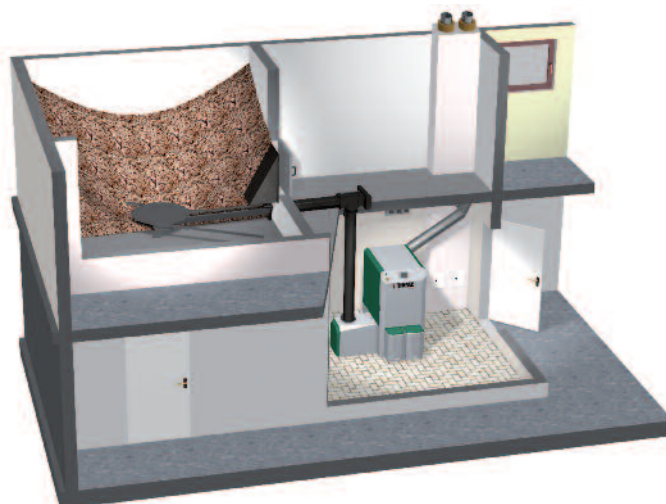
Almacén y sala de calderas a distintos niveles. Descarga horizontal mediante agitador rotativo y tubo de caída.
