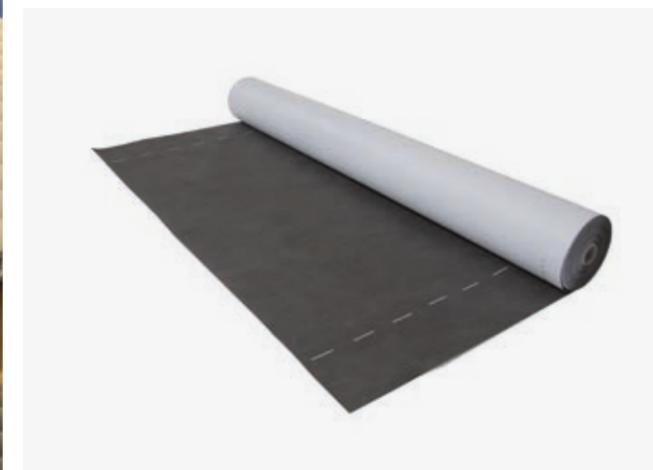
Es una lámina impermeable al agua pero permeable al vapor de agua utilizada para el control del vapor en cubiertas inclinadas y fachadas ventiladas para instalar bajo la protección y sobre la estructura portante, apoyando en las vigas o apoyando en el tablero (forjado de hormigón, maderas, paneles...) o directamente sobre el aislamiento térmico.
