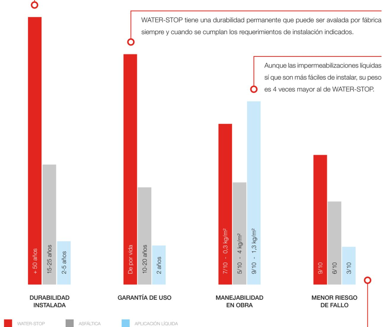
Los impermeabilizantes líquidos, aunque se instalan con facilidad conllevan un mayor riesgo frente a las láminas impermeabilizantes que aseguran su estanqueidad en procesos productivos controlados y auditados. Además, los factores ambientales como la humedad, la temperatura o el viento pueden alterar el resultado esperado en impermeabilizantes líquidos. WATER-STOP se une entre sí sin necesidad de aplicar calor en junta como necesitan las asfálticas, conllevando un menor riesgo.
