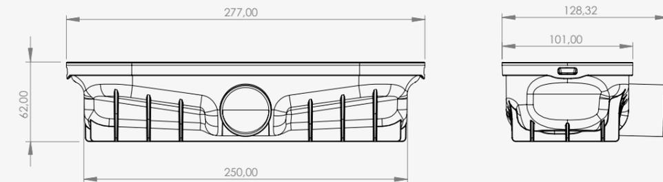
**TRYPHON VERTICAL:** Salida Ø 50 mm | Conexión con junta a presión
