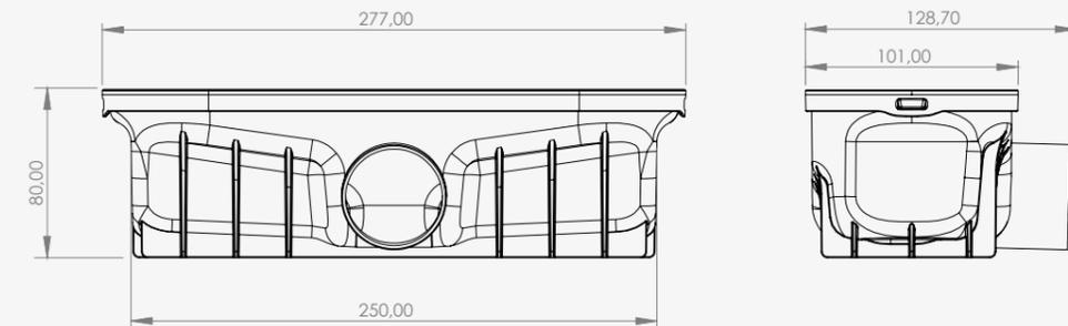
**TRYPHON REDUCIDO:** Salida Ø 40 mm | Conexión mediante encolado
