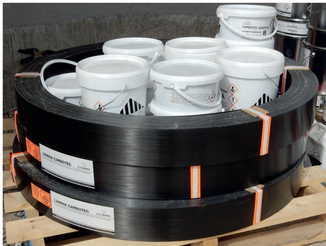
Puesta en obra de las Láminas Carbotec, fabricadas mediante un proceso de pultrusión a partir de filamentos de fibra de carbono dispuestos en una matriz epoxídica.
