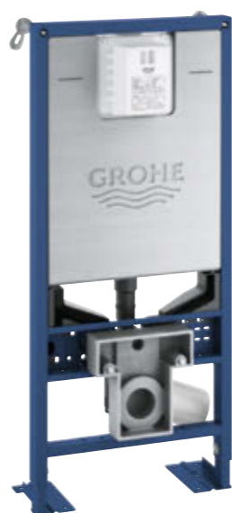
39 599 000 Rapid SLX WC 3-6 | 1,13 m F, con patas para carga pesada Módulo Rapid SLX para inodoro, altura de instalación de 1,13 m con cisterna de descarga GD2, enchufe eléctrico, control de flujo, acceso sencillo y totalmente aislado frente a la condensación. Con patas para carga pesada.
