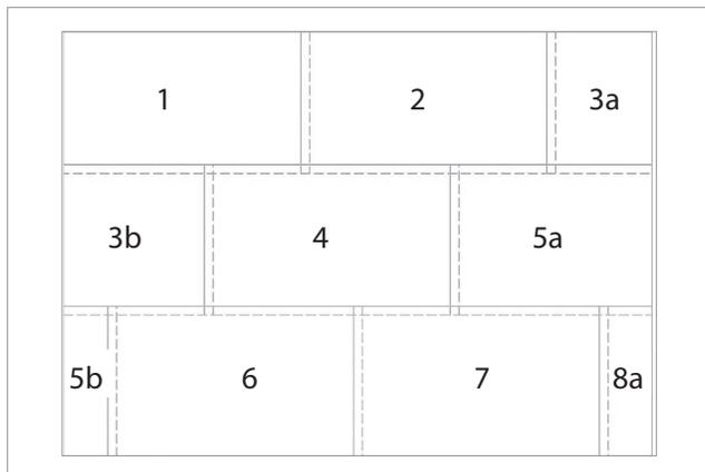
Se quitan los dos bordes excedentes de la placa n. 1, simplemente usando un cutter, y ésta se coloca en el rincón más adecuado para empezar la instalación. La placa n. 2 se recorta sólo en su lado mayor. El borde en el lado menor permitirá el anclaje con la placa n. 1. Esta operación deberá repetirse en todas las placas de la primera fila.
