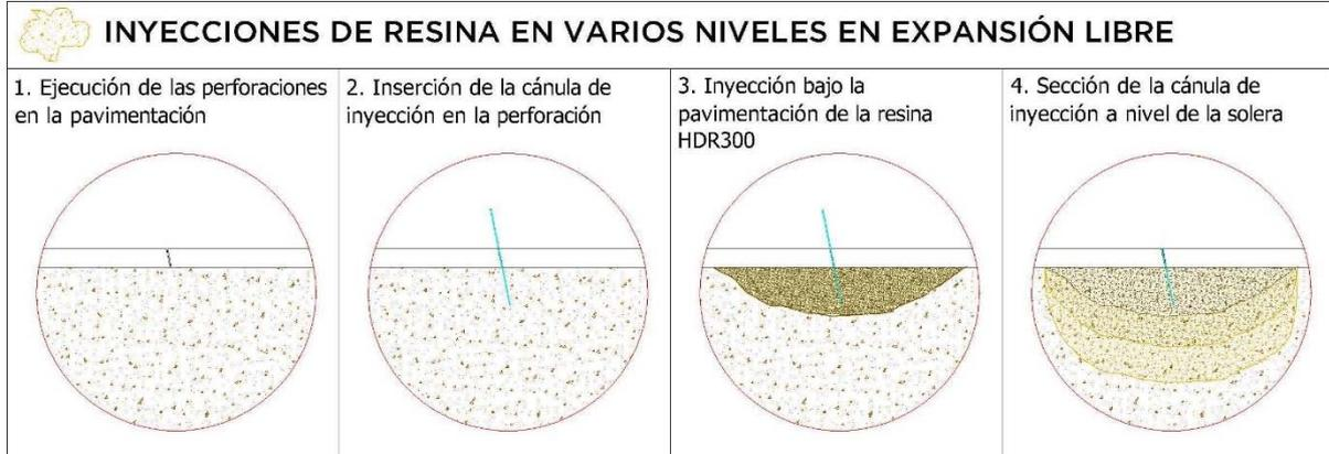
Esquema de las fases de ejecución de las inyecciones de resina.
