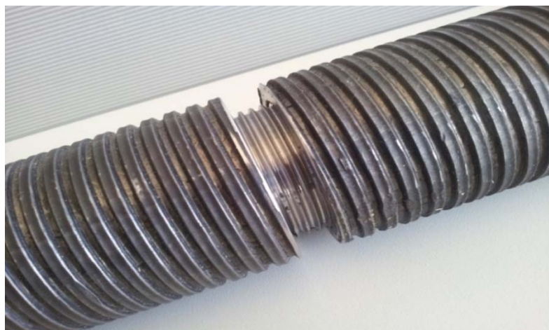
Detalle rosca exterior del micropilote.
