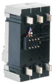
La parte móvil se acopla al interruptor y consta de un juego de conectores que reemplazan las conexiones frontales. También incluye un enclavamiento de disparo, que dispara el interruptor cuando se extrae de la parte fija y previene de la inserción en dicha parte fija del interruptor
