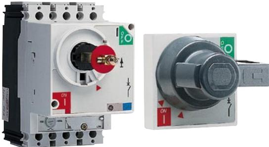
El mando y un marco de puerta se montan en el frontal de la puerta, conectando mecánicamente al frontal del interruptor a través de un eje prolongador instalado en la caja adaptadora. El diseño permite hasta una profundidad total de 350mm (desde la parte del interruptor montado tras la puerta hasta la parte frontal de la puerta).
