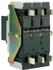
La parte móvil se acopla al interruptor y consta de un juego de conectores que reemplazan las conexiones frontales. También incluye un enclavamiento de disparo, que dispara el interruptor cuando se extrae de la parte fija y previene de la inserción en dicha parte fija del interruptor si se encuentra cerrado.
