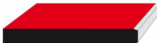
Figura 2.2: Panel con cantos biselados.
