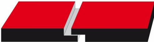
Figura 4.1: Junta con galce.
