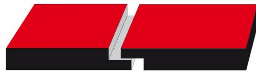
Figura 4.1: Junta con galce.
