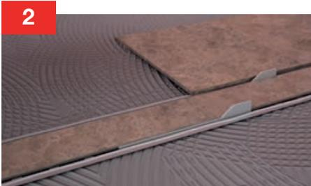
3. Aplicar un cordón de masilla selladora tipo W-S MASTIC sobre los perfiles laterales y proceder a colocar el pavimento pegando directamente sobre la lámina con cemento cola tipo C2.
