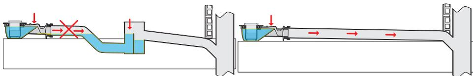
El cuerpo del sistema está diseñado como sífónico, pero si se tiene que instalar con un bote sífónico externo, el retén de agua se puede anular para evitar el riesgo de obstrucción por doble sifón: basta con retirar la pieza tubular (1) y a continuación, abrir el fondo del tubo de salida (2). Para ello hay una sección preparada con línea de rotura controlada que se puede romper fácilmente con un destornillador o similar (3).
