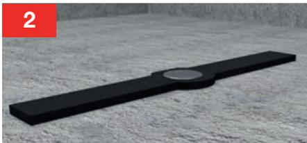
La plantilla viene a la medida adecuada para la canaleta de 120 cm. Para ajustarla a la medida de su canaleta hay que recortar simétricamente las dos alas, para ello siga las líneas de pre-corte y quitando sucesivamente los tramos se obtiene la medida para las canaletas de 100, 90, 80, 70 y 60.
