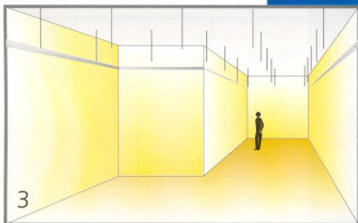
**3. POSICIONAR** sobre el paramento horizontal (forjado), líneas paralelas a los perfiles primarios, y sobre ellas los puntos de anclaje para los cuelgues, separados entre sí la distancia de 0,6 a 1 metro.
