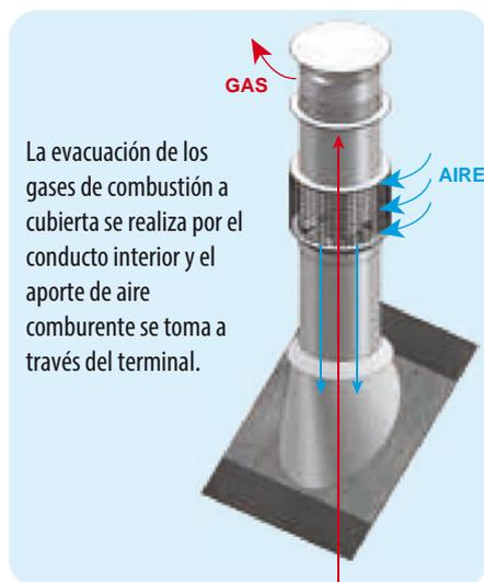
La evacuación de los gases de combustión a cubierta se realiza por el conducto interior y el aporte de aire comburente se toma a través del terminal.
