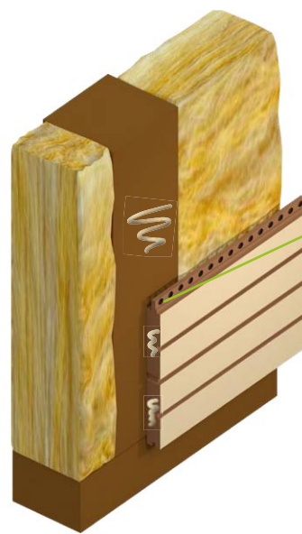
Sistema de montaje 3: clavado y encolado
