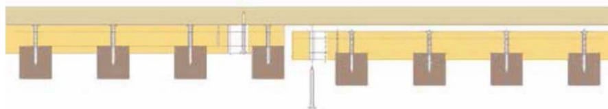
**Montaje a techo con estructura T24 y pletinas**
