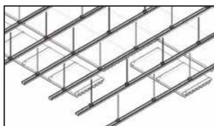
Todos los modelos también se pueden montar atornillados debajo de un rastrelado fijado al techo como por ejemplo un rastrelado de perfiles T60 tipo Pladur.
