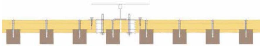
**Montaje a techo con estructura T60 y tornillos**
