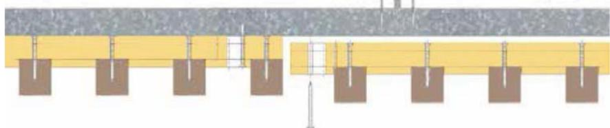
Todos los sistemas de montaje permiten un fácil desmontaje para acceder a instalaciones existentes detrás de los paneles
