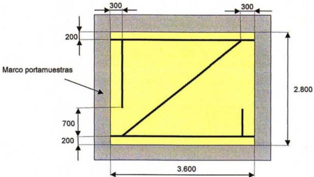
**Figura 3:** Croquis de las rozas realizadas por ambas caras de la muestra ensayada (301-H3). Cotas en mm.
