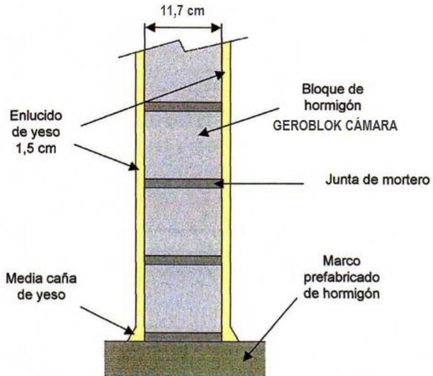
**Figura 1:** Esquema de la muestra ensayada (301-H3)
