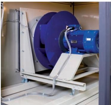
La pintura epoxi de Dantherm ofrece la mayor resistencia anticorrosión del mercado. Toda la estructura, así como los pequeños componentes, se revisten con esta pintura una vez son fabricados y justo antes del proceso de montaje.
