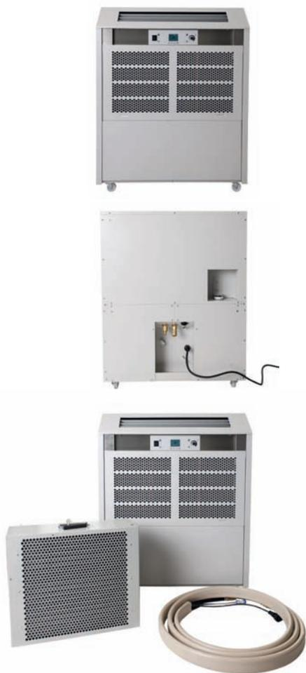
*El ACT-7 requerirá la conexión a una pequeña unidad condensadora externa a través de dos mangueras flexibles auto-sellantes que contienen agua. Estas mangueras se suministran con 5m o 15m de longitud y se pueden conectar a una longitud máxima de 30m.*
