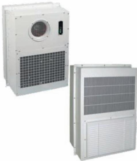
Los equipos termosifones DC se utilizan **para la refrigeración de cabinas y espacios que tienen equipos electrónicos sensibles**. Estos dispositivos utilizan el método termodinámico de intercambio de calor pasivo basado en la convección natural del interior. En el proceso de refrigeración, la unidad hace circular el fluido refrigerado sin necesidad de compresor.
