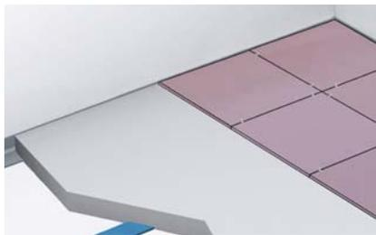
5. Verter cemento cola tipo ARGOCOLA® Élite 600 mezclado con resina de látex (140 g/kg de ARGOCOLA®) directamente sobre el producto y colocar las piezas cerámicas con los separadores para cuadrar las distintas piezas.
