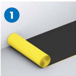
1. Extender la lámina en el sentido longitudinal de los tableros.
