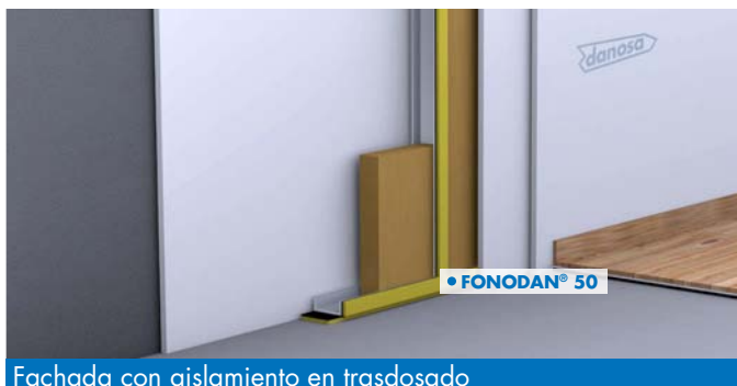
Fachada con aislamiento en trasdosado
