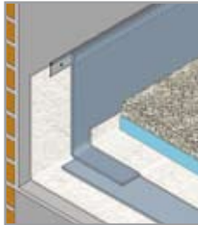
Cubierta con Danolosa
