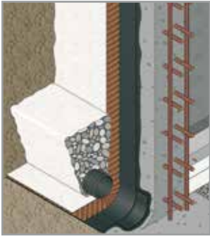
Muros enterrados (sin presión hidrostática)
