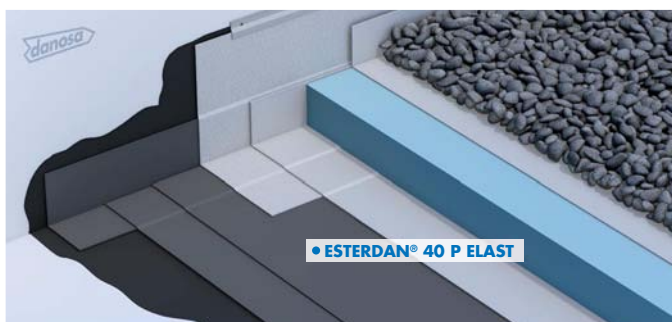
Cubierta plana invertida no transitable
