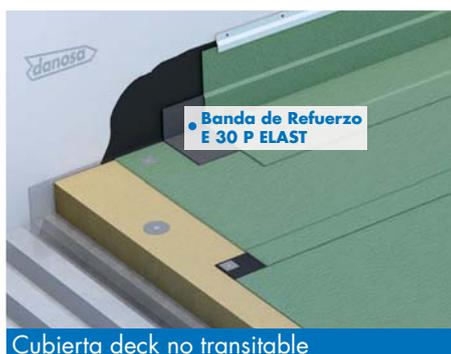
Cubierta deck no transitable
