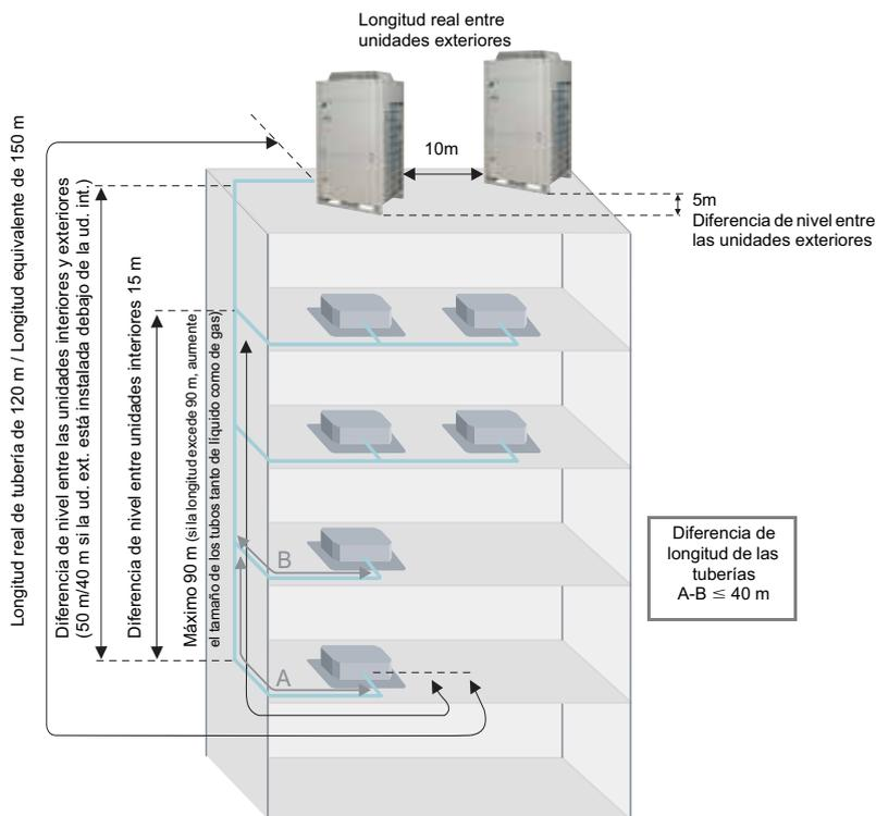
Longitud total de tubería: 300m
