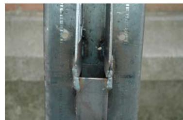
En los modelos de prótesis sobre madera antigua, donde la geometría de la prótesis por la parte inferior hace que se pase de un tubo estructural del 60.40.4 a una sola pletina de 4 mm de espesor y 60 mm de altura, el fallo por soldadura fue general (**Figura nº 5.37**).
