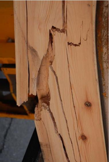
RECUPERACIÓN DE LA CAPACIDAD MECÁNICA EN PIEZAS DE MADERA SOLICITADAS A FLEXIÓN EN ESTRUCTURAS TRADICIONALES OPERANDO POR LA CARA SUPERIOR MEDIANTE REFUERZOS Y PROTESIS METÁLICAS
