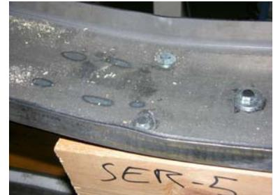
En las piezas suplementadas de madera antigua se produce el fallo por soldadura antes mencionado, y los tornillos de borde no sufren arrancamiento del plano de la madera (**Figura nº 5.43**).
