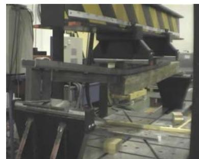
Al llegar la carga a un valor determinado durante los ensayos el programa detecta que ya no hay resistencia de la pieza, cayendo la línea en la gráfica y cesando la carga en ese momento.
