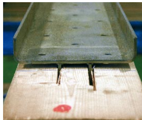
Refuerzo de acero de doble pletina inferior sobre la madera.
