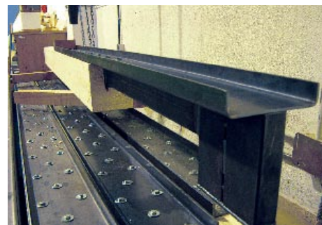
Prótesis de madera con doble pletina inferior.
