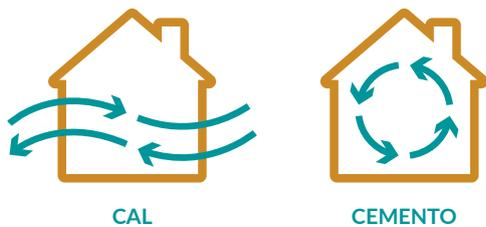
COM-CAL TRADICIONAL es transpirable, poroso y permeable, lo que genera una envolvente del edificio que evita la acumulación de humedad en el interior de las estancias, por ello mejora la habitabilidad del edificio, las condiciones de salubridad (al disminuir el riesgo de condensaciones) y permite una renovación natural del aire interior.
