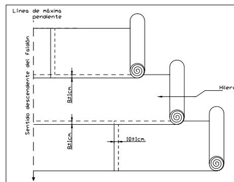
**A PREVIO.** Se preparará la superficie y aplicarán las fijaciones de la hilera de inicio. Y se completará toda la hilera. Se recortarán las faldillas, ajustando al borde del alero.
