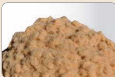
**GUTEX Thermofibre®** se compone de pura fibra de madera de abeto de los bosques de la selva negra. Por su bajo valor lambda ofrece una protección excelente al frío y supone un ahorro energético y de dinero importante. Con las fibras especialmente abiertas a la difusión de vapor se consigue un confort interior muy agradable.
