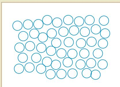
El efecto de todos los aislantes térmicos se basa en la creación infinita de células de aire, porque lo que realmente aísla es el aire, siempre y cuando se trate de aire compartimentado en múltiples espacios pequeños y de forma estanca. ¡Tanto en las plumas del pato, como en nuestro aislamiento de la vivienda!
