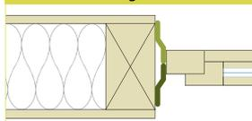
CONTEGA IQ se adhiere con la primera franja adhesiva lateralmente al marco de la ventana y con la segunda a la moqueta del muro de fábrica.
