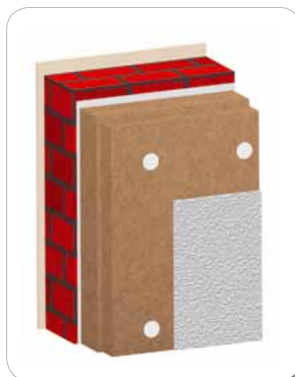
Fachada revocada, dos capas
