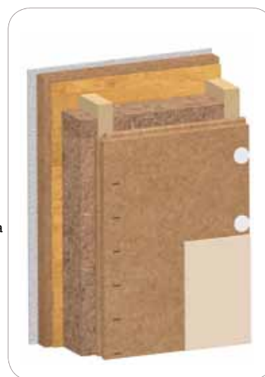
Fachada revocada/ interiormente plano de instalaciones
