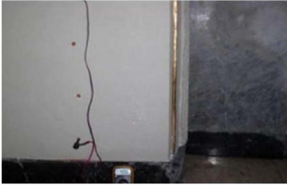
**Comprobación del potencial eléctrico** en el muro midiendo con un tester electrónico las corrientes presentes en el muro para determinar el funcionamiento del dispositivo **BIODRY**.
