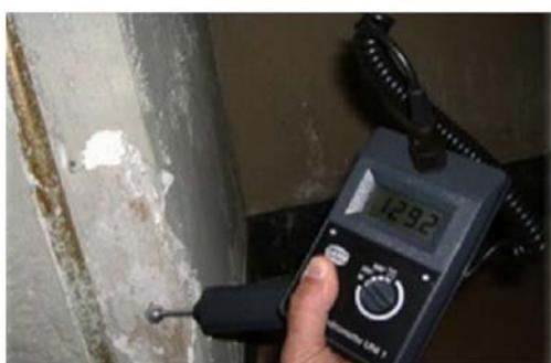
**Mediciones de la superficie** con un medidor de impulsos eléctricos, que mide el estado de humedad superficial del enlucido en 2 cm. de espesor. Este medidor superficial se basa sobre diferentes resistencias eléctricas que presenta el enlucido según el agua contenida. La conductibilidad eléctrica del enlucido o del mortero no solo depende del agua contenida sino también de las sales disueltas, por lo que se realizan también otras mediciones.
