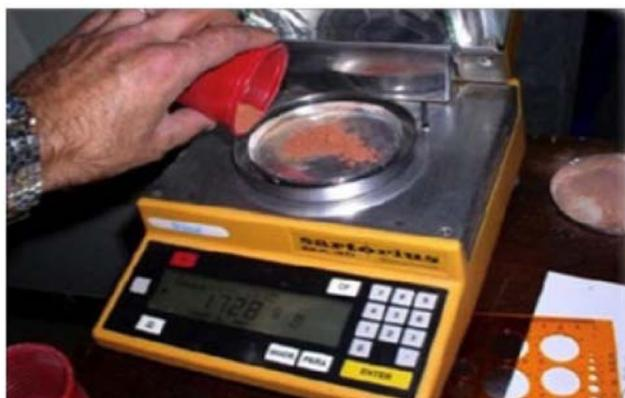
Instrumento utilizado: **balanza de alta precisión** con hornillo de secado incorporado, calibrada según dicha normativa, que permite cuantificar exactamente la humedad en el interior del muro. El resultado se expresa en % de peso de agua, o bien el instrumento extrae el peso bruto (muro + agua) y lo registra.
