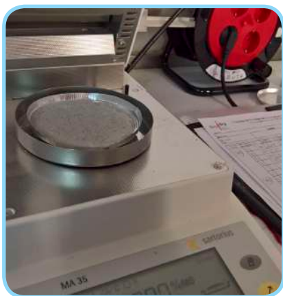
Mediciones de humedad mediante muestras extraídas del interior del muro
