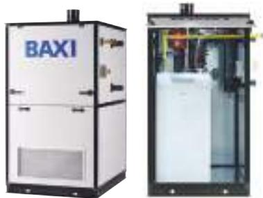
**Grupos modulares autónomos para su instalación en el exterior formados por 1 ó 2 calderas de pié Eurocondens SGB** conectadas en cascada y montadas dentro de armarios. Disponibles con botella de equilibrio o intercambiador de placas acorde a la potencia del conjunto.
