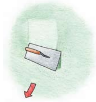
Figura 45 Estriado del UniversalFüllputz con llana de acero sobre estructura raspada 1,5
