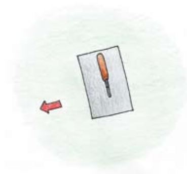
Figura 46 Extendido del UniversalFüllputz con ayuda de un fratás de plástico
