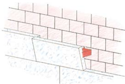
Figura 15 Colocación de los paneles aislantes
