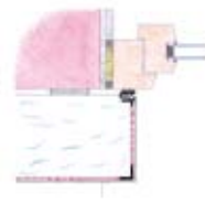
Figura 32 Baunit FensteranschlussProfil flexible
