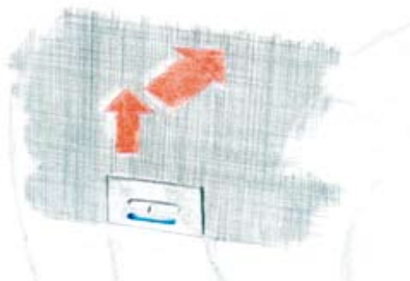
Figura 38 Debe evitarse un alisado excesivo, las rebabas de la espátula eventualmente generadas deberán eliminarse una vez secas
