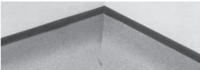
3. Doble el segundo lateral hacia el centro y córtelo cuidadosamente para terminar la esquina. Pegue y suelde la junta.
