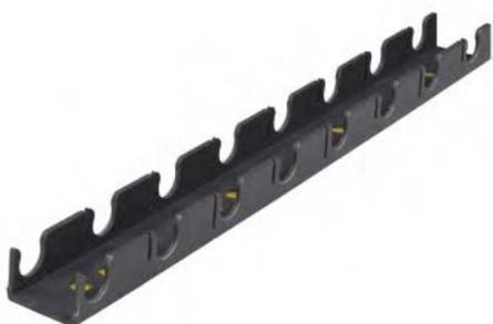
Barra de tendido para tubo multicapa de 17 mm y de 20 mm (uso industrial), autoadhesiva; con encajes en intervalos de 5 cm. Incluye una base autoadhesiva, para su fijación al panel aislante.
