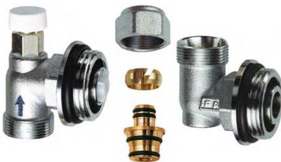
Conjunto de recirculación para colocación en colector (IDA y RETORNO). Incluye juntas tóricas, conexiones roscadas 24x19. Apto para tubo multicapa.
