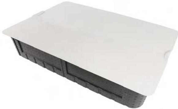
Caja fabricada en Polipropileno expandido de dos centímetros de grosor. Tapa exterior acabada en aluminio lacado en blanco. Incorpora guías galvanizadas para montar las fijaciones del colector. El diseño de la tapa permite regular su colocación para aumentar la profundidad; permite adaptarse tanto al montaje interior como al espesor del muro en el que se empotre la caja.
