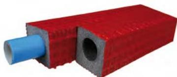
Coquilla aislante ALB de 25 mm de altura, fabricada en espuma de polietileno PE con un agujero excéntrico de 18 mm para el paso de tubos, corrugados o tubos multicapa.
