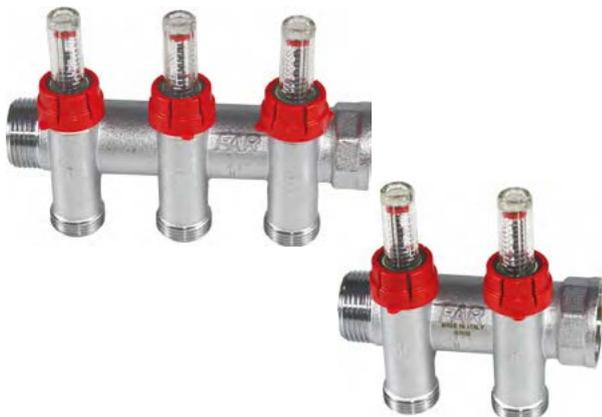
Caudalímetros reguladores de caudal para el equilibrado de circuitos. Derivaciones con conexión para bicono intercambiable para tubo multicapa, plástico y cobre.
