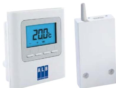
Kit compuesto por un termostato para calefacción/refrescamiento y un receptor inalámbrico. Conjunto diseñado para funcionar de forma autónoma: el receptor dispone de una salida on/off para conectar directamente a una válvula de zona, un arranque/paro de bomba o a una fuente de calor en función de la señal del termostato. Es posible proporcionar control remoto vía internet añadiendo la pasarela ALB código 23420. El receptor de este kit no es compatible con la base de conexiones ALB.
