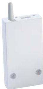
Dispositivo necesario para comunicar la base de conexiones con los termostatos vía radio, o la base con la pasarela de conectividad ALB. Por lo tanto es un elemento necesario para la regulación vía radio y para el control remoto a través de internet. La conexión del receptor con la base de conexiones es cableada. Se recomienda cable par trenzado de sección mínima 0,6 mm<sup>2</sup> y no superar los 30 metros de longitud total.
