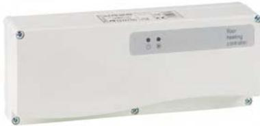
Permite centralizar la conexión de termostatos on/off cableados y los cabezales de los circuitos. Es el nexo entre todos los elementos de control de la regulación ambiente. Todos los elementos del sistema son cableados y funcionan en modo todo/nada. La base de conexiones dispone de una salida 230V para control de bomba circuladora y salida libre de tensión para dar señal a caldera o aerotermia.
