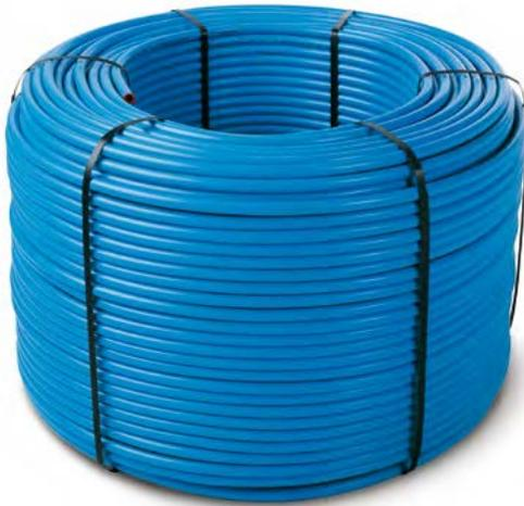
Tubo multicapa ALB azul para climatización radiante, compuesto por una capa interior en polietileno PE-RT (DOWLEX 2388), una capa intermedia en aluminio de 0,2/0,25 mm de espesor, soldada a testa, y una capa exterior en polietileno (PE-RT).
