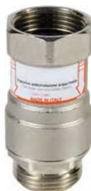
ALB stop cooling valve es un dispositivo anticirculación de agua fría diseñado para su instalación en sistemas de suelo radiante para calefacción y refrigeración. Su función es evitar la circulación de agua fría en aquellas zonas donde se pueda producir condensaciones como puede ser los baños. El dispositivo incorpora un termostato interno tarado a 19°C: cuando la temperatura del agua desciende por debajo de ese valor, el dispositivo bloquea el paso del agua.
