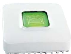
Elemento necesario únicamente si se quiere disponer de conectividad remota vía internet. Se comunica de forma inalámbrica con el receptor ALB (cableado a la base de conexiones).
