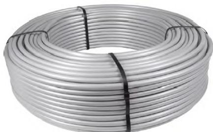
El tubo multicapa ALB diámetro 16 x 2 mm SUPERFLEX está compuesto por una capa interior de polietileno PE-RT-I, una capa interna de aluminio soldada a testa, y una capa externa de polietileno PE-RT-I.
