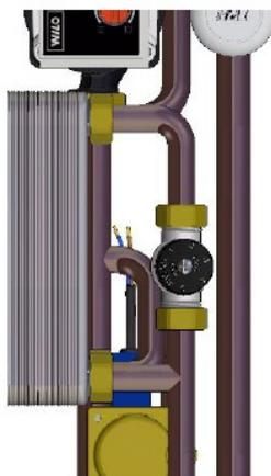
El intercambiador de calor de placas termosoldadas es el elemento que permite la transferencia de energía térmica entre el circuito primario (montantes) y el secundario (interior de la vivienda) sin que los flujos de uno y otro se mezclen.
