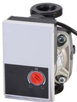
Bomba circuladora electrónica para sistemas de climatización domésticos, de 130 mm de longitud. Velocidad, presión y caudal variable. Funciona a 230 V.c.a., 50 - 60 Hz. Está compuesta por un sistema hidráulico, un motor de rotor húmedo con rotor de imán permanente y un módulo de regulación electrónico con convertidor de frecuencia integrado. Está equipado con un indicador LED que informa del estado de la bomba.
