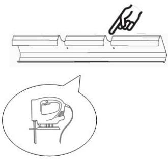
2. Preparar el perfil de pladur para el paso de tubos y los orificios para los tornillos
