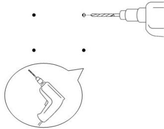
2. Realizar los orificios en la pared
