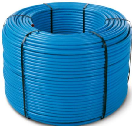
El tubo multicapa ALB azul para climatización radiante está compuesto por una capa interior de polietileno (PE-RT, Dowlex 2388), una capa interna de aluminio de 0,2 mm de espesor soldada a testa, y una capa externa de polietileno (PE-RT).
