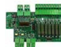
Passerelle pour équipement électromécanique
