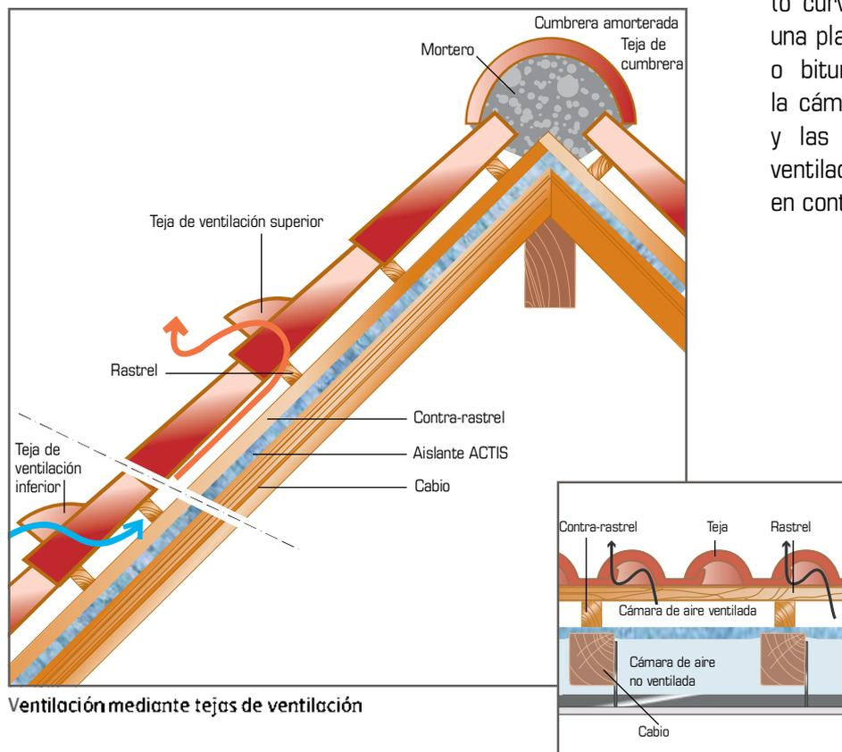
Ventilación mediante tejas de ventilación
