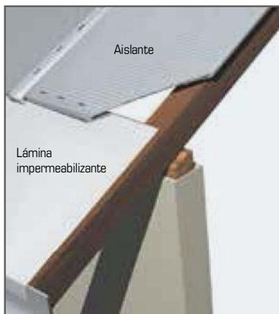
Al final del rollo solapar con el siguiente grapando el solape sobre un soporte de madera fijado previamente.
