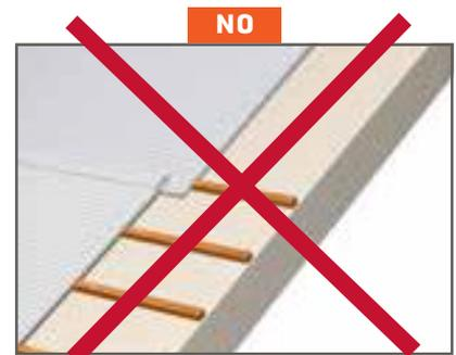
El tramo superior recibe siempre el tramo inferior. El solape se efectúa siempre sobre un listón
