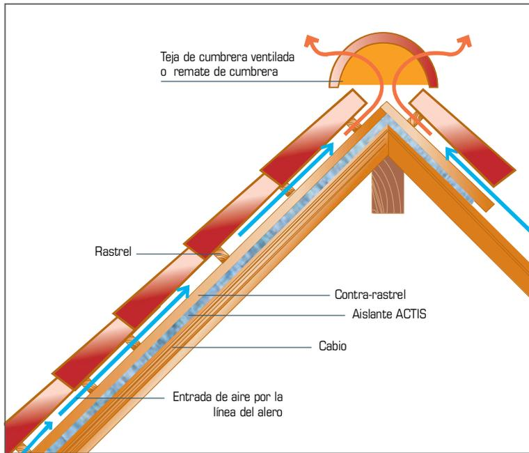
Ventilación mediante entrada de aire por la línea del alero y salida superior en la cumbretera
