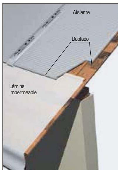
Al llegar al final del rollo, solapar con el siguiente grapando el solape sobre un rastrel fijado previamente.
