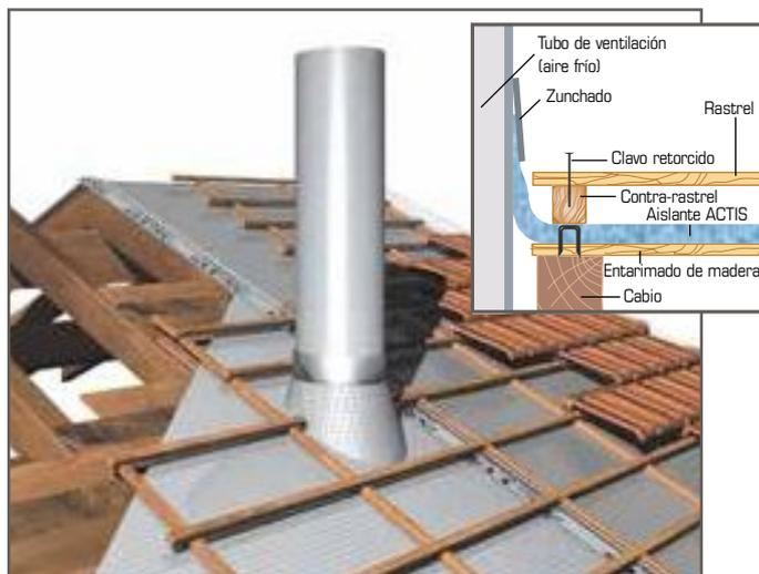
**¡ATENCIÓN!** Excluir todo contacto entre el aislante y el plomo, el cobre y sus aleaciones, así como todos los productos decapantes. En caso de soldadura, aunque se utilice una manta de protección, apartar el aislante ACTIS de la zona de trabajo y asegurarse que ninguna partícula incandescente o chispa entre en contacto con el aislante.
