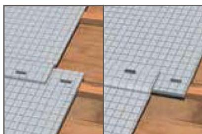
En caso de un alero importante (en la parte baja del faldón o en el contorno del tejado), es posible aislar únicamente hasta 50 mm después de la pared maestra y colocar en la parte del alero una lámina impermeabilizante para facilitar la evacuación del agua en caso de infiltración accidental.
