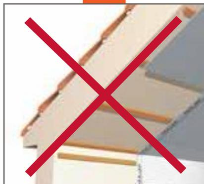
Sentido de colocación del aislante siempre idéntico al sentido de colocación de los rastreles sobre el soporte. El solape de los franos se efectúa siempre grupado sobre un rastrel.
