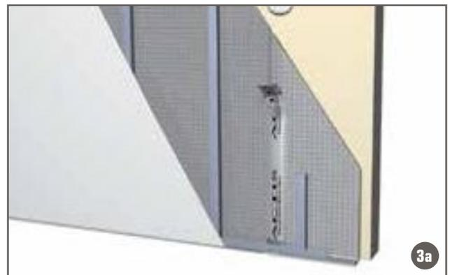
No dejar el aislante visto en las zonas habitables. La colocación de un acabado debe ser realizada por personal cualificado de acuerdo con las normas vigentes y especificaciones de los fabricantes.
