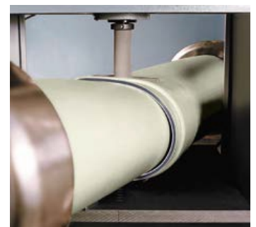
Prueba de estanqueidad | Leak test
