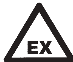
Zona con riesgos de atmósferas explosivas
