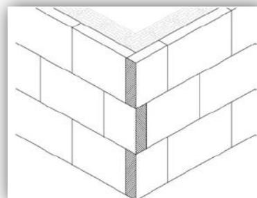
Las placas serán colocadas inmediatamente después de la aplicación del adhesivo, y se colocarán en su posición final, presionando contra el soporte con la ayuda de una llana con el objetivo que el mortero de adhesión se extienda, ajustando los bordes y planimetría a las placas adyacentes de modo que no haya holguras entre placas y eliminando los restos de material existentes en los bordes.
