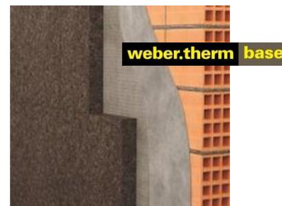
Sobre soportes planos, el mortero de adhesión se puede aplicar en toda la superficie de la placa, con una llana dentada (de dientes de 9-10 mm). Pudiendo ser necesario aplicar también mortero en el soporte, en caso que exista en éste alguna irregularidad que dificulte el contacto perfecto con la placa (comprobar la planimetría de las placas y que el mortero de adhesión de la placa está en contacto con el soporte en la totalidad de la superficie).
