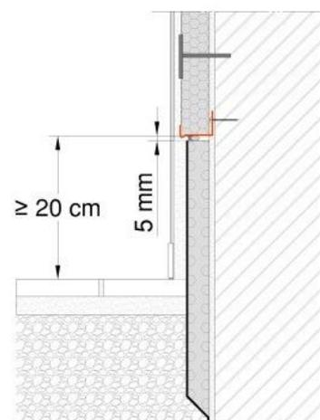
Una vez impermeabilizado el soporte de acuerdo con lo descrito en el punto 4.2.1, y revestidas las placas con **weber.therm base** reforzado con malla, se deberá impermeabilizar la zona enterrada de la pared del SATE aplicando un mortero impermeabilizante **weber.tec imperflex** o mortero bituminoso tipo **weber.tec 915** desde unos 15-20 cm por debajo del arranque de las placas y hasta unos 15-20 cm por encima del nivel del suelo.
