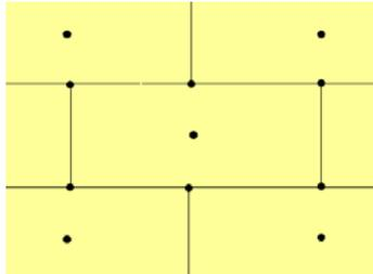
La cabeza circular de las espigas deberá ser presionada de modo que quede enrasada con la superficie de la placa aislante, para no tener salientes en el plano de la placa. Las pequeñas cavidades resultantes de las hendiduras deberán ser posteriormente rellenadas con mortero de regularización, en una operación previa al revestimiento de las placas.
