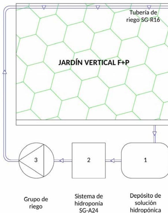
La solución hidropónica circula en el sentido de la numeración (1-2-3) pasando por la superficie del jardín vertical y retornando al depósito por gravedad.
