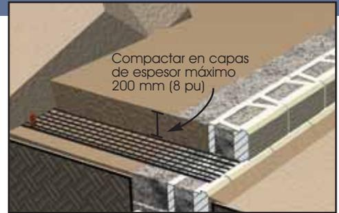
Compactar en capas de espesor máximo 200 mm (8 pu).
